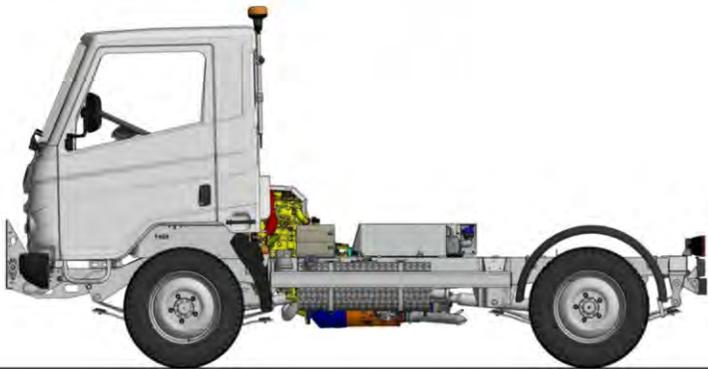
Die Fahrgestellversion wird in zwei Radständen (2.220 und 2.550 mm) produziert und neben dem klassischen Kippaufbau auch für verschiedene Anwendungen eingesetzt, darunter: Absetzkipper, Kanalspülaufbau, ... und Sonderaufbauten z.B. Feuerwehr
