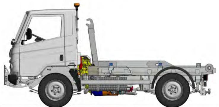
Die Abrollkipperversion HEN/CTS wird in der Variante mit langem Radstand (2.550 mm) hergestellt und ist für Behälter mit Trägerabständen von 1060 mm ausgelegt, mit 900 mm Hakenhöhe. Das Gerät ist mit einem verschraubten Hilfsrahmen starr am Rahmen befestigt.
