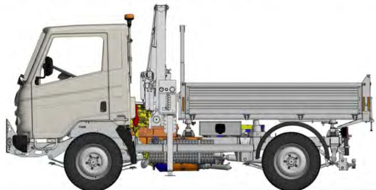
Die Kippversion mit Kran FASSI F30CY.023 wird in der Variante mit langem Radstand (2.550 mm) hergestellt und ist mit einer Blechplattform und von unten zu öffnenden Seitenwänden aus TR5-Legierung für ein Volumen von ca. 1,4 m<sup>3</sup> ausgestattet. Kataphorese-Korrosionsschutzbehandlung und Doppelschichtlackierung. Um den Aufbau zu vervollständigen, kann der vordere Kabinenschutz (optional) hinzugefügt werden.
